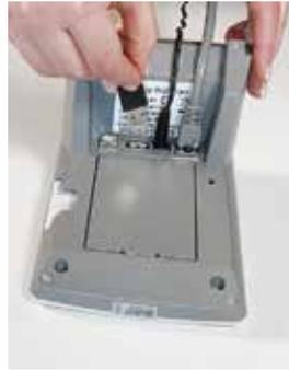
Der Aufsatz wird über den USB-Anschluss mit dem Gerät verbunden.
