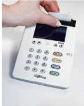
Vor der Verklebung erfolgt die exakte Positionierung mithilfe einer eingesteckten Chipkarte.
